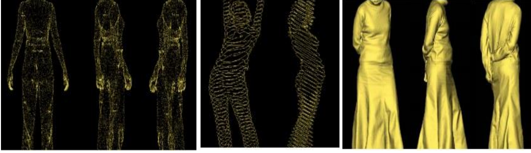
Resim 3.4. Soldan sağa sırasıyla Polyworks vücut tarayıcının noktasal, dilim alanı ve yüzeyel görüntüleri.
