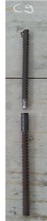
Şekil A.30. x firmasına ait Ø32 MANŞONLU_C9 kademeli çevrimsel çekme deneyi gerilme-şekil değişirme grafiği ve deney sonrası kopma görüntüsü
