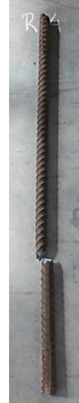
Şekil A.4. x firmasına ait Ø26 referans numunesi-4 monotonik çekme deneyi gerilme-şekil değişirme grafiği ve deney sonrası kopma görüntüsü
