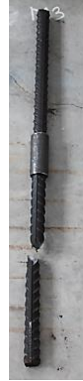
Şekil A.8. x firmasına ait Ø32 MANŞONLU_3 monotonic çekme deneyi gerilme-şekil değişirme grafiği ve deney sonrası kopma görüntüsü
