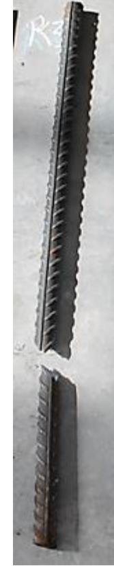
Şekil A.3. x firmasına ait Ø32 referans numunesi-3 monotonic çekme deneyi gerilme-şekil değişirme grafiği ve deney sonrası kopma görüntüsü
