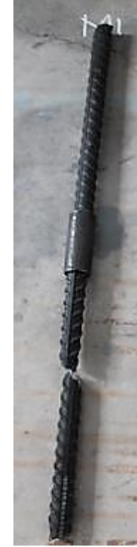
Şekil A.6. x firmasına ait Ø32 MANŞONLU_1 numunesi monotonic çekme deneyi gerilme-şekil değişirme grafiği ve deney sonrası kopma görüntüsü
