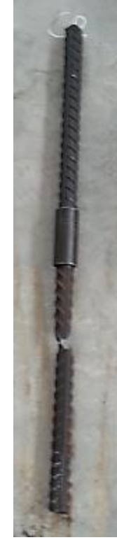
Şekil A.21. x firmasına ait Ø32 MANŞONLU_C2 kademeli çevrimsel çekme deneyi gerilme-şekil değişirme grafiği ve deney sonrası kopma görüntüsü
