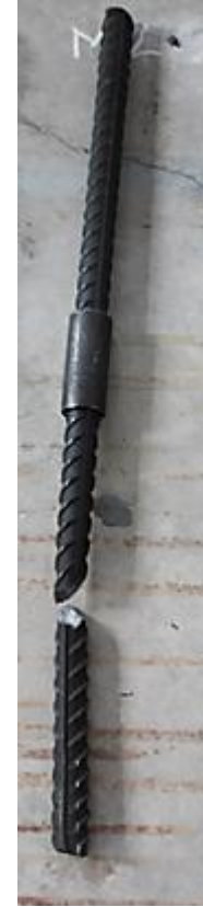
Şekil A.7. x firmasına ait Ø32 MANŞONLU_2 monotonik çekme numunesi deneyi gerilme-şekil değişirme grafiği ve deney sonrası kopma görüntüsü
