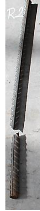
Şekil A.2. x firmasına ait Ø32 referans numunesi-2 monotonik çekme deneyi gerilme-şekil değişirme grafiği ve deney sonrası kopma görüntüsü
