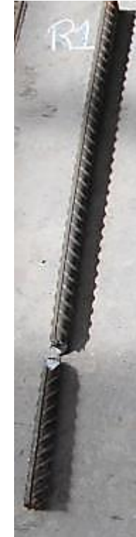
Şekil A.1. x firmasına ait Ø32 referans numunesi-1 monotonik çekme deneyi gerilme-şekil değişirme grafiği ve deney sonrası kopma görüntüsü
