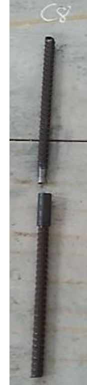
Şekil A.29. x firmasına ait Ø26 MANŞONLU_C8 kademeli çevrimsel çekme deneyi gerilme-şekil değişirme grafiği ve deney sonrası kopma görüntüsü
