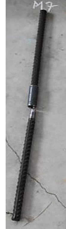
Şekil A.12. x firmasına ait Ø26 MANŞONLU_7 monotonic çekme numunesi deneyi gerilme-şekil değişirme grafiği ve deney sonrası kopma görüntüsü
