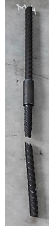
Şekil A.9. x firmasına ait Ø32 MANŞONLU_4 monotonic çekme deneyi gerilme-şekil değişirme grafiği ve deney sonrası kopma görüntüsü
