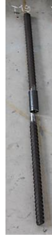
Şekil A.14. x firmasına ait Ø26 MANŞONLU_9 monotonik çekme deneyi gerilme-şekil değişirme grafiği ve deney sonrası kopma görüntüsü
