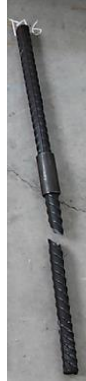
Şekil A.11. x firmasına ait Ø32 MANŞONLU_6 numunesi monotonik çekme deneyi gerilme-şekil değişirme grafiği ve deney sonrası kopma görüntüsü
