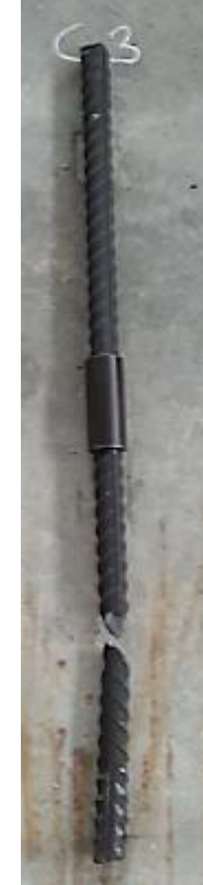
Şekil A.22. x firmasına ait Ø32 MANŞONLU_ C3 kademeli çevrimsel çekme deneyi gerilme-şekil değişirme grafiği ve deney sonrası kopma görüntüsü
