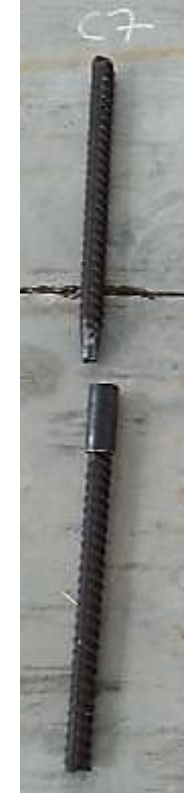
Şekil A.28. x firmasına ait \varnothing 26 MANŞONLU_C7 kademeli çevrimsel çekme deneyi gerilme-şekil değişirme grafiği ve deney sonrası kopma görüntüsü
