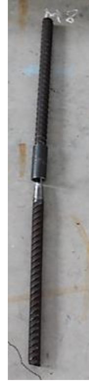
Şekil A.13. x firmasına ait Ø26 MANŞONLU_8 monotonik çekme deneyi gerilme-şekil değişirme grafiği ve deney sonrası kopma görüntüsü
