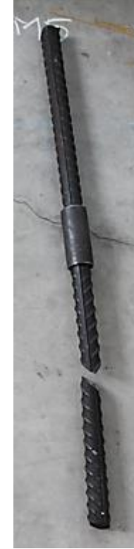
Şekil A.10. x firmasına ait Ø32 MANŞONLU_5 monotonik çekme deneyi gerilme-şekil değişirme grafiği ve deney sonrası kopma görüntüsü
