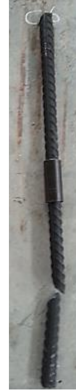
Şekil A.25. x firmasına ait Ø32 MANŞONLU_C6 kademeli çevrimsel çekme deneyi gerilme-şekil değişirme grafiği ve deney sonrası kopma görüntüsü
