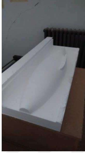
Görsel 3.16. Gövde üretimi (iki parçalı)
