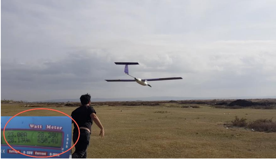
Görsel 5.15. Hydra (6,1 kg) elden atıldıktan kısa süre sonra hava tutunabilmesi için ölçülen güç değeri
