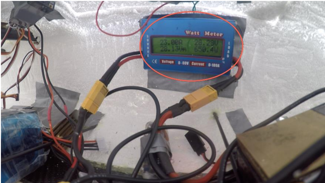
Görsel 5.16. Hydra (6,1 kg) elden atıldıktan kısa süre sonra hava tutunabilmesi için ölçülen güç değeri uçak içinden alınan görüntü
