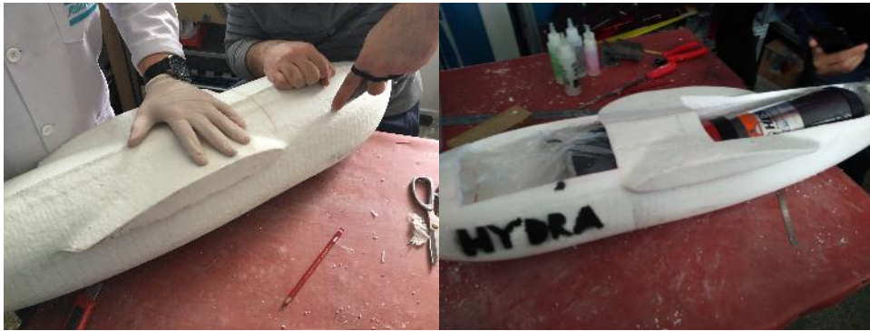
Görsel 3.17. Gövde üzerinde küçük silindirin yerleşimi
