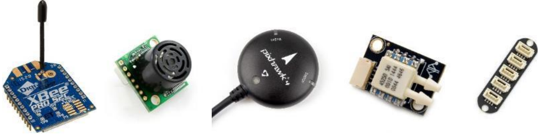
Görsel 3.6. (Soldan sağa) Telemetri, Sonar mesafe sensörü, GPS modülü, hava hızı sensörü, I2C çoğaltıcısı.
