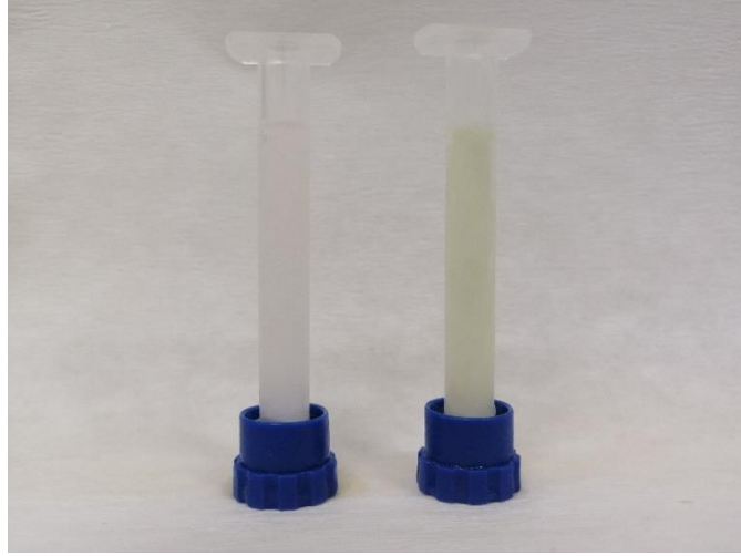
Görsel 3.6. Soldaki kolon poli (HEMA), sağdaki kolon poli(HEMA-ko-Mg-şelataz)
