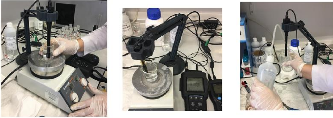
Şekil 5.14. Nitrat ve amonyum probu ile ölçümlerin yapılması
