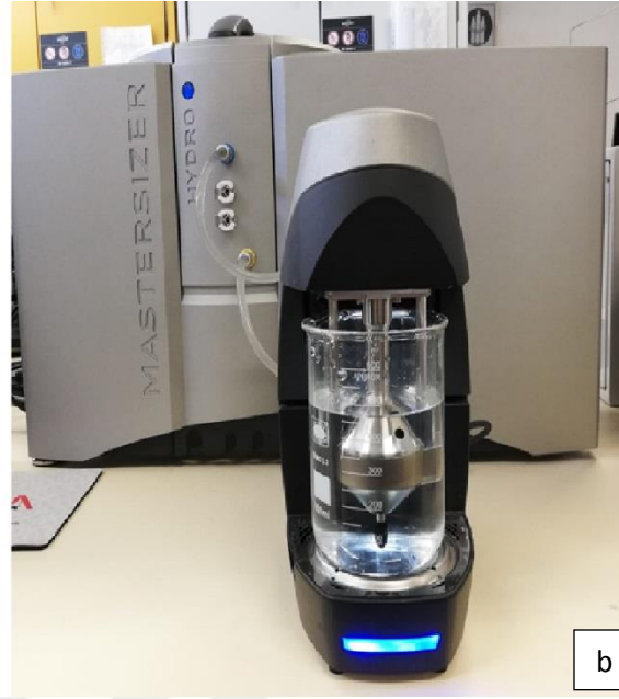
Şekil 5.11. a: elek analizi ve b: partikül boyut analizine ait görsel
