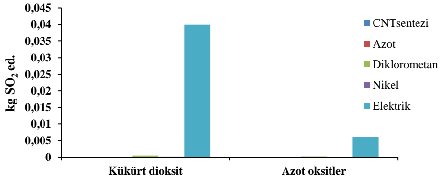
Şekil 6.15. 0,553 g CNT sentezinin AP etkisi (CNT sentezi, azot üretimi, diklorometan üretimi, nikel üretimi, elektrik)
