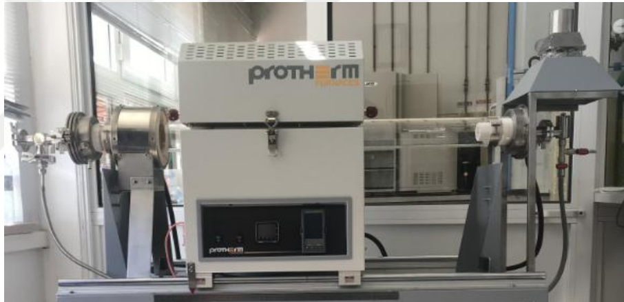
Grsel 5.2. CNT sentezinde kullanılan kimyasal buhar ktrme fırını
