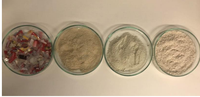
Görsel 5.1. LDPE, atık kil, atıksu arıtma çamuru ve zeolit örnekleri
