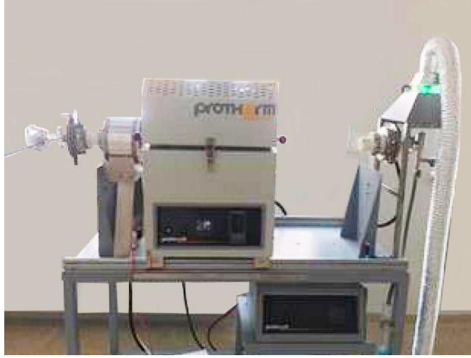
Görsel 5.12. CNT sentezinde kullanılan kimyasal buhar çöktürme fırını
