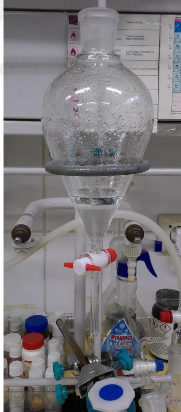
Görsel 4.1. Etil asetat ile kestrakte edilen PCDA/NHS/EDC karışımının su ile yıkanması.
