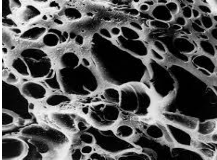
Şekil 2.3. Aktif karbonun gözenek yapısı
