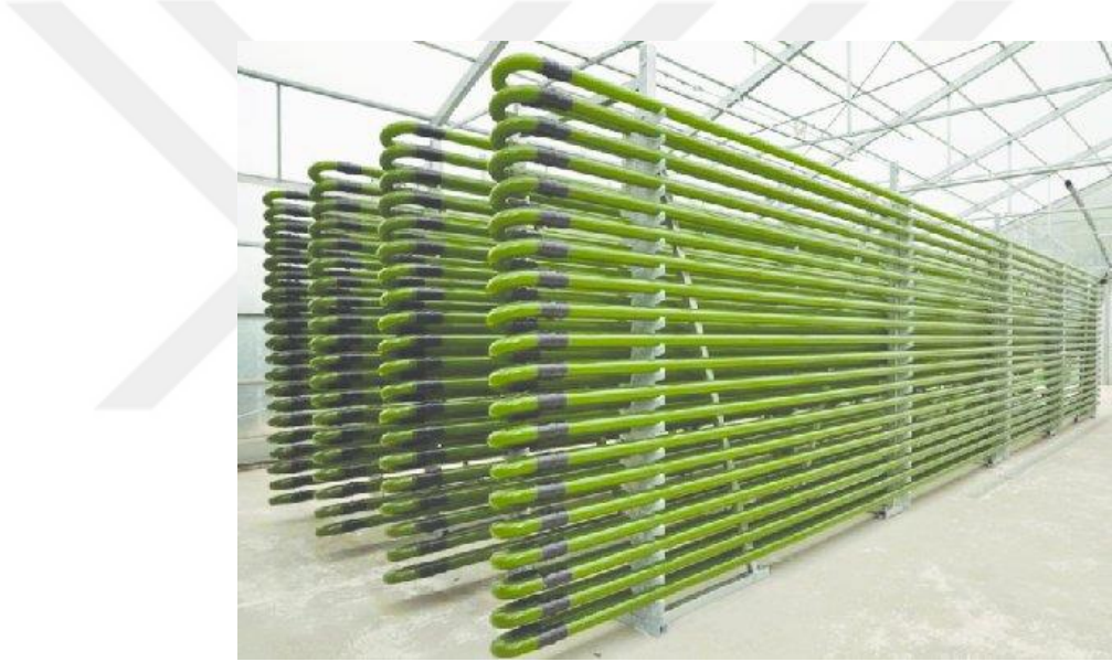
Görsel 2.2. Tübüler fotobiyoreaktör sistemi görünümü [37]
