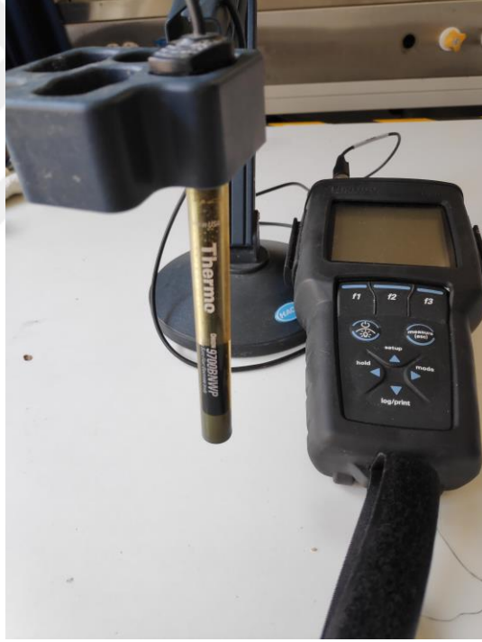
Görsel 4.7. Thermo Orion Star A329 multi ölçüm cihazı ve nitrat probu
