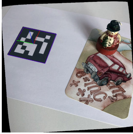
Görsel 3.21. t=0.15 için hesaplanmış kamera matrisi ile sentezlenmiş görüntü
