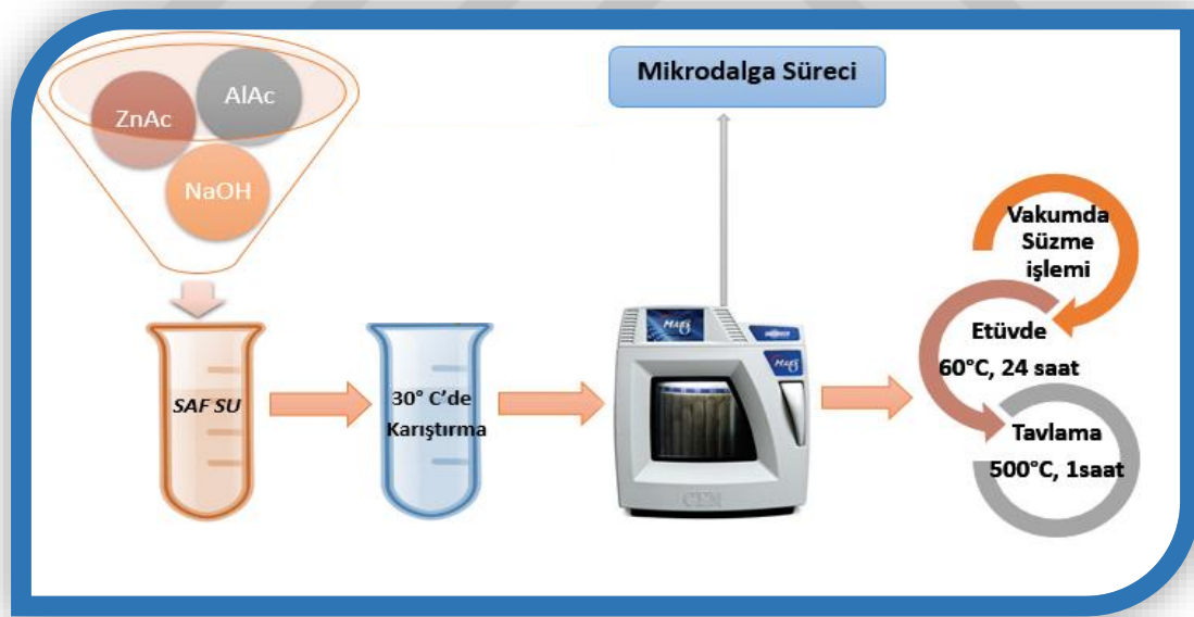
Şekil 4.2. Al katkılı ZnO nanotozunun elde edilme şeması
