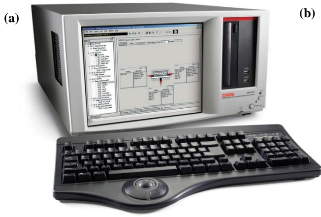
Şekil 3.22. (a) Keithley 4200-SCS yarıiletken karakterizasyon sistemi (b) C-10 adaptör kutusu
