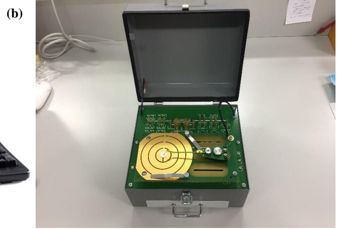
Şekil 3.22. (a) Keithley 4200-SCS yarıiletken karakterizasyon sistemi (b) C-10 adaptör kutusu
