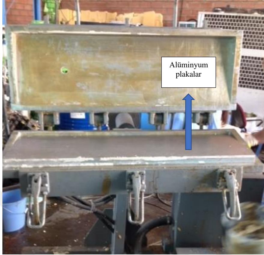
Şekil 4.3. Mini mold kalıbı içine yerleştirilen alüminyum plakalar
