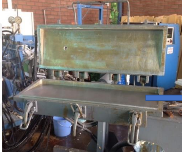
Şekil 4.2. Alüminyum plaka yerleştirilmiş halde mini mold kalıbı görüntüsü
