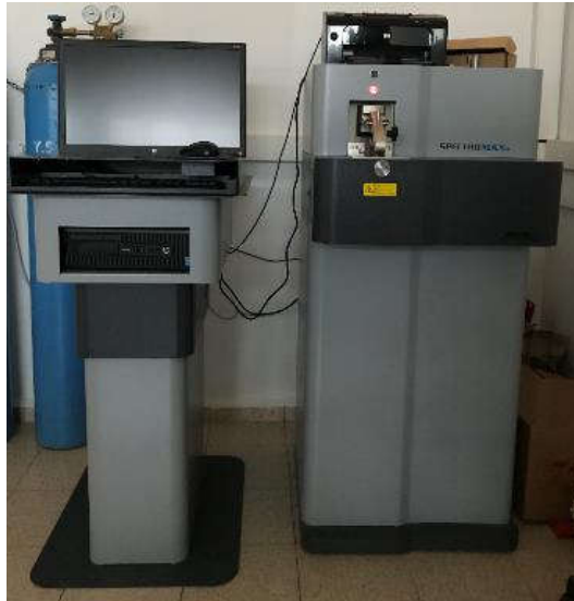
Şekil 5.2. SPEKTROMAXx, Spectro Analytical Instruments GmbH, Germany UV-VIS spektrometresi.
