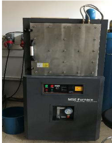
Şekil 5.3. Çözeltili alma ve yaşlandırma işlemlerinde kullanılan fırın.
