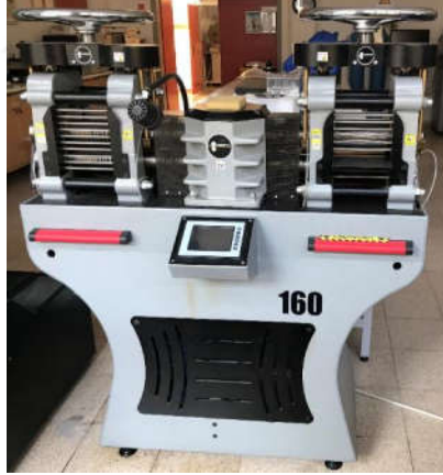
Şekil 5.4. Haddelme/deformasyon işlemlerinde kullanılan hadde.
