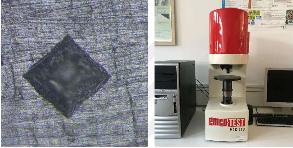
Şekil 5.6. (a) Vickers izinin optik görüntüsü (b) Sertlik ölçüm cihazı.
