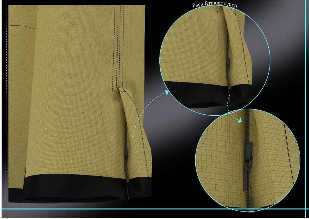
Şekil 10.14. İtfaiyeci giysisi pantolon paçası fermuar detayı
