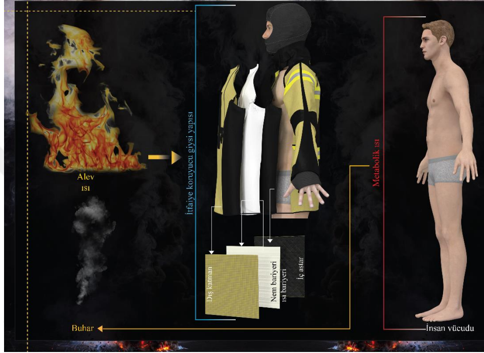
Şekil 6.2. İtfaiyeci giysi yapısı koruyucu özellikleri
