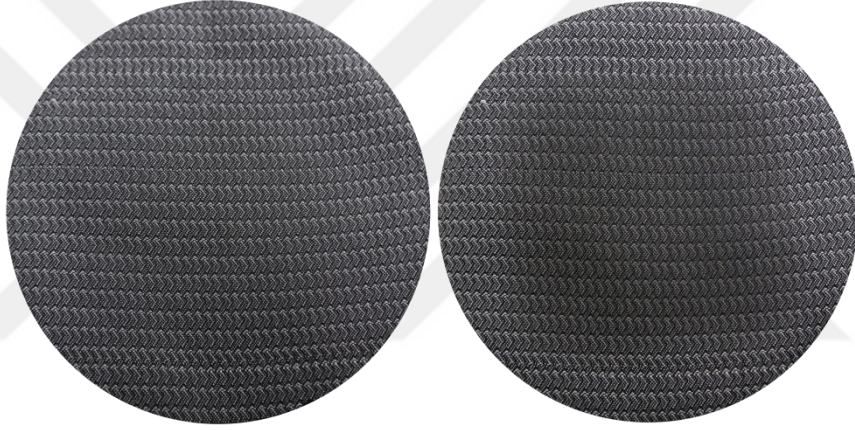
Görsel 7.18. Aşınma dayanım testi öncesi ve sonrası numune 6'nın görünümü
