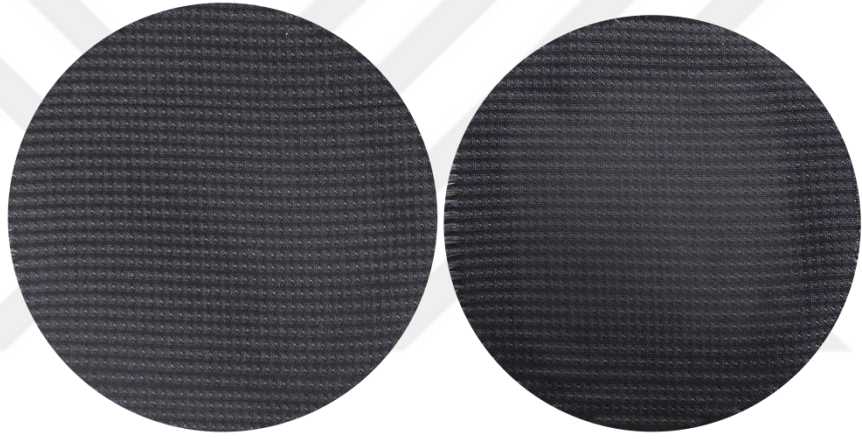
Görsel 7.15. Aşınma dayanım testi öncesi ve sonrası numune 3'ün görünümü
