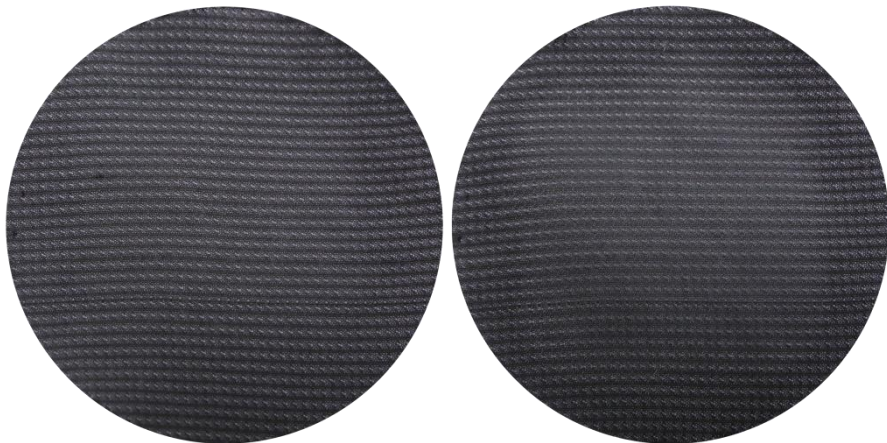
Görsel 7.16. Aşınma dayanım testi öncesi ve sonrası numune 4'ün görünümü
