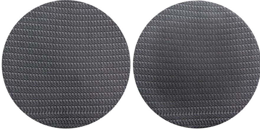
Görsel 7.17. Aşınma dayanım testi öncesi ve sonrası numune 5'in görünümü
