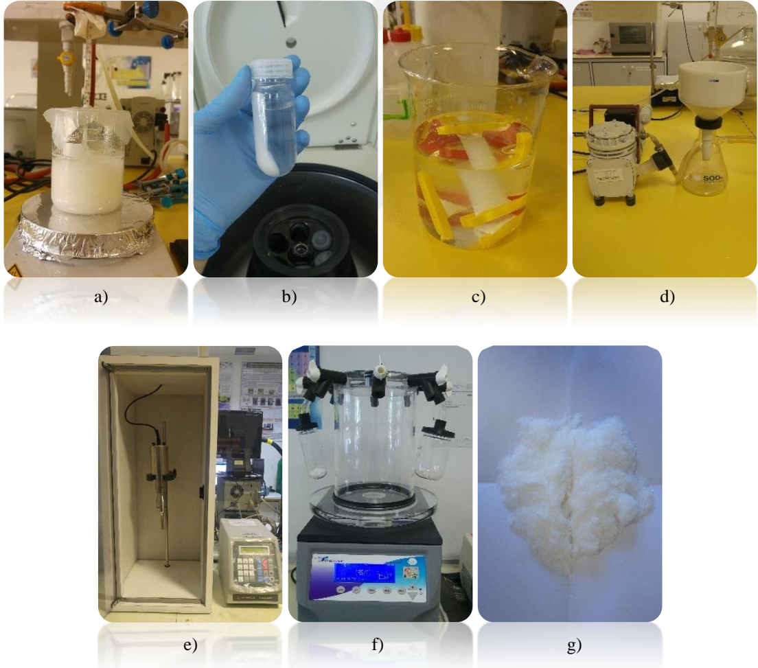
Görsel 3.1. Nanoselüloz üretimi, a) Sülfirik asit ile hidroliz, b) Santrifüj ile yıkama (pH ayarlanması), c) Ultra saf su ile diyaliz membran , d) Vakumlu filtrasyon, e) Ultrasonikasyon ile dağıtma, f) Liyofilizatörde kurutma, g) Ürün (NC lifleri)
