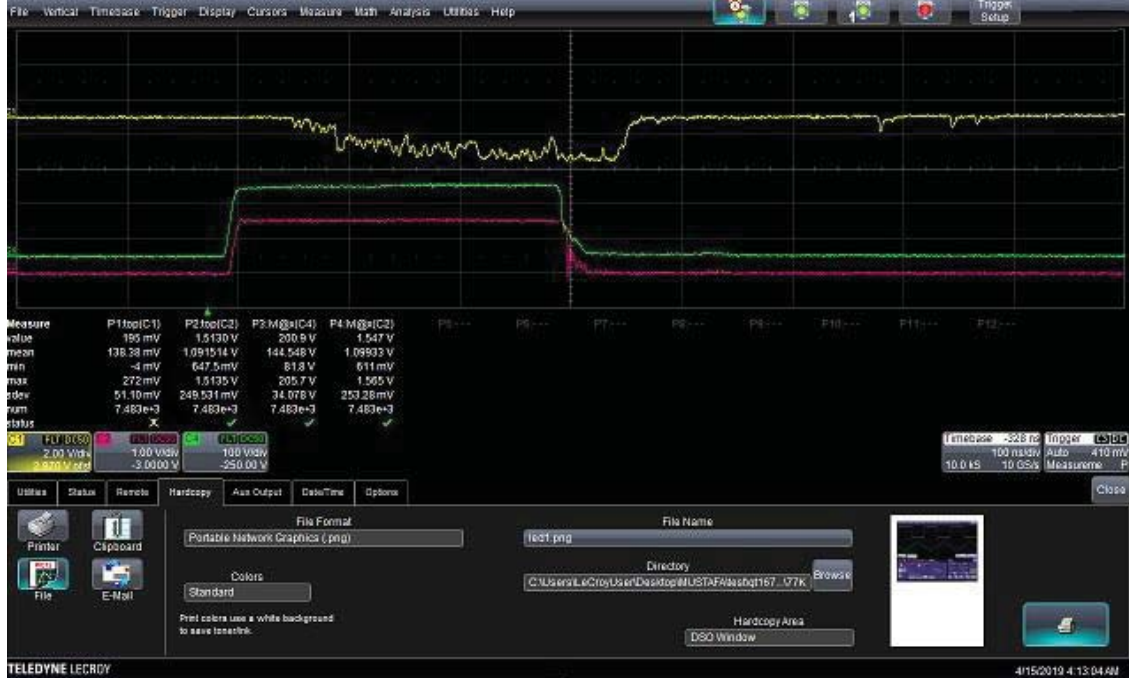
Şekil 5.15. THH EL düzeneği ile yapılan ölçümdeki osiloskop ekran görüntüsü Sarı renkte olan sinyal osiloskobun birinci kanalından gözlemlenen elektrolüminesans sinyalini, osiloskobun dördüncü kanalında yeşil ile gösterilen kare dalga örneğe uygulanan pulslu voltajı ve osiloskobun ikinci kanalındaki kırmızı kare dalga ise yük direnci üzerine düşen voltajı göstermektedir.
