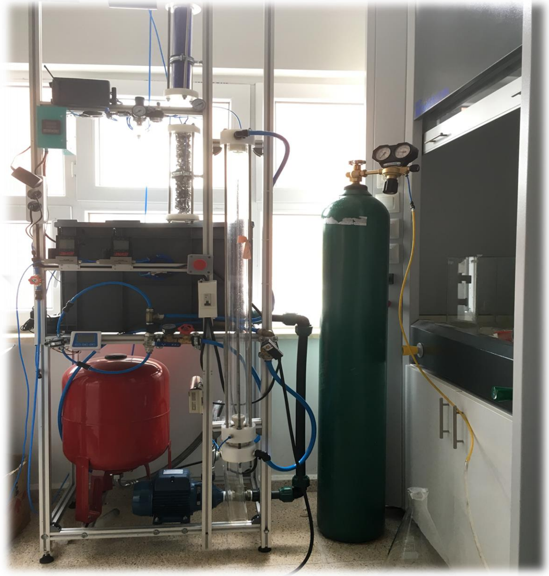
Şekil 4. 4.CO 2 absorpsiyonu deney düzeneği
