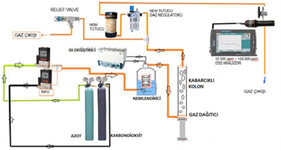
Şekil 4. 3. Kabarcık kolon CO 2 absorpsiyonu deney düzeneği akış şeması
