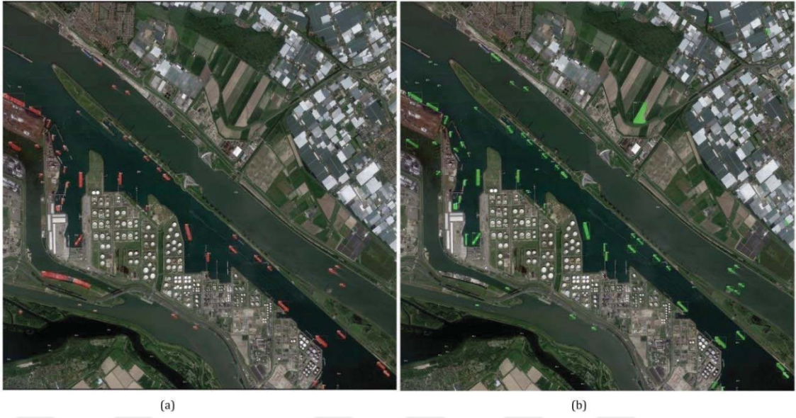
Şekil 5.10. BG-1 görüntüsü içinden bir kesitte a) eğitimde pozitif örnek sayısı kadar negatif örneğin kullanıldığı modelle yapılan tespit, b) eğitimde sadece pozitif örneklerin kullanıldığı modelle yapılan tespit
