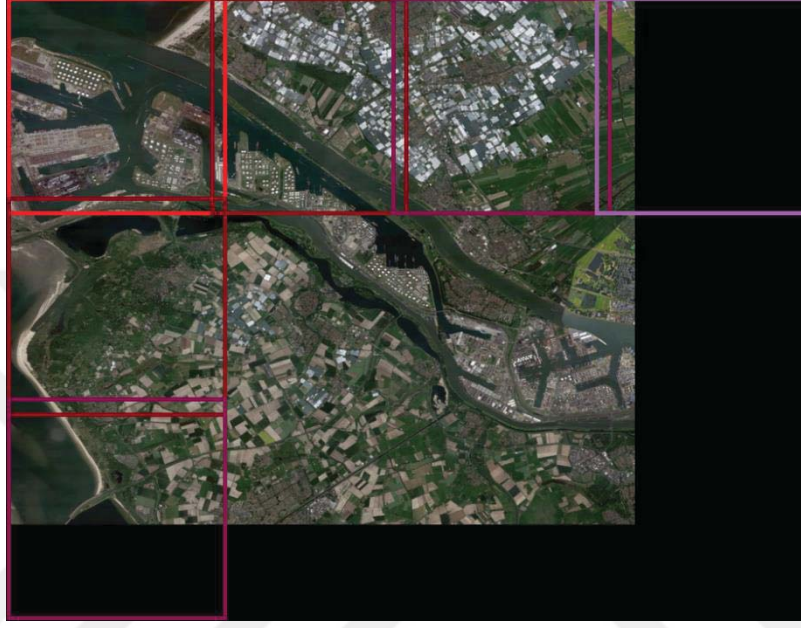
Şekil 5.8. Boyutu 5120 \times 5120 pikselin üzerinde olan görüntüler bu büyüklükteki parçalara bölünerek modele girilmektedir.
