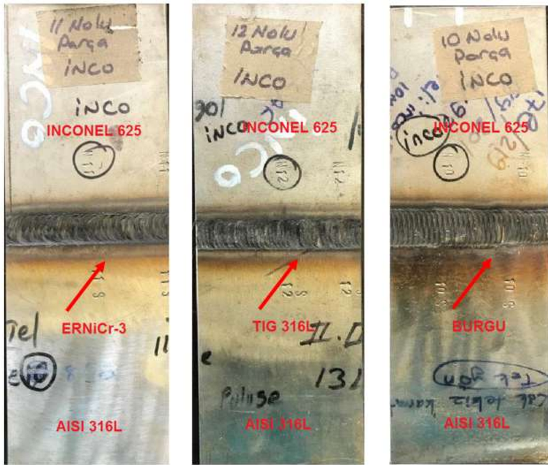
Şekil 4.4. DA/TIG kaynak yöntemi kullanılarak yapılan kaynak dikişleri d) ERNiCr-3, e) TIG 316L, f) Burgu (ErNiCr-3 + TIG 316L)
