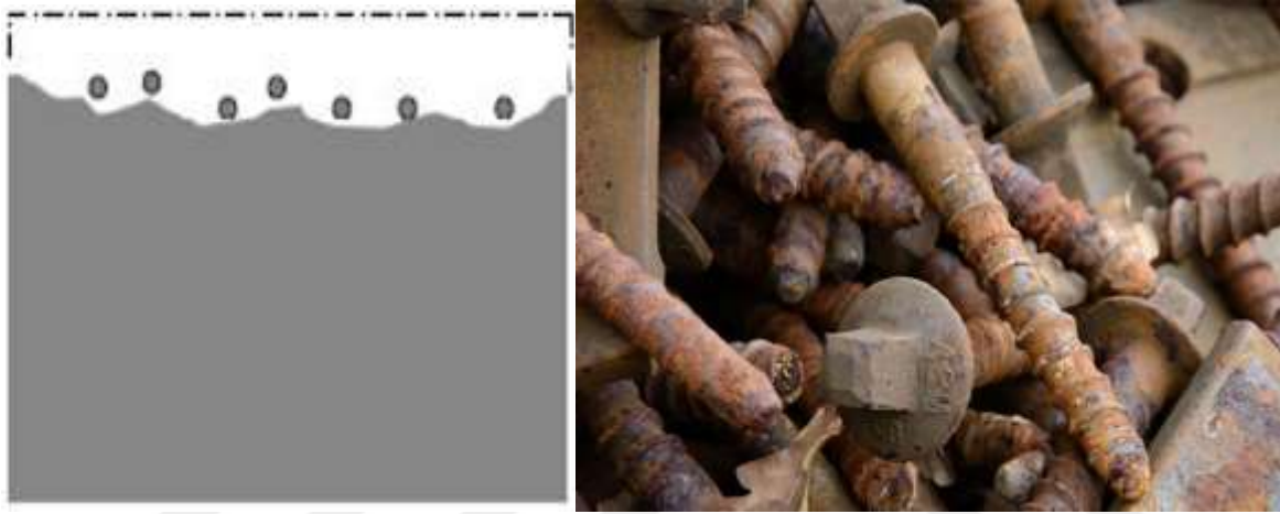
Şekil 2.16. Homojen dağılımlı korozyon
