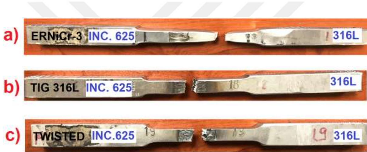
Şekil 4.36. SA/TIG kaynak yöntemi ile yapılan deneylerin çekme testi sonuçları a) ERNiCr-3 ile kaynatılmış, b) TIG 316L ile kaynatılmış ve c) Burgu (ERNiCr-3 + TIG 316L) ile kaynatılmış
