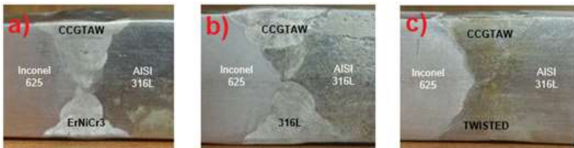
Şekil 4.3. SA/TIG kaynak yöntemi kullanılarak yapılan kaynak dikiş kesitleri a) ERNiCr-3, b) TIG 316L, c) Burgü (ErNiCr-3 + TIG 316L)
