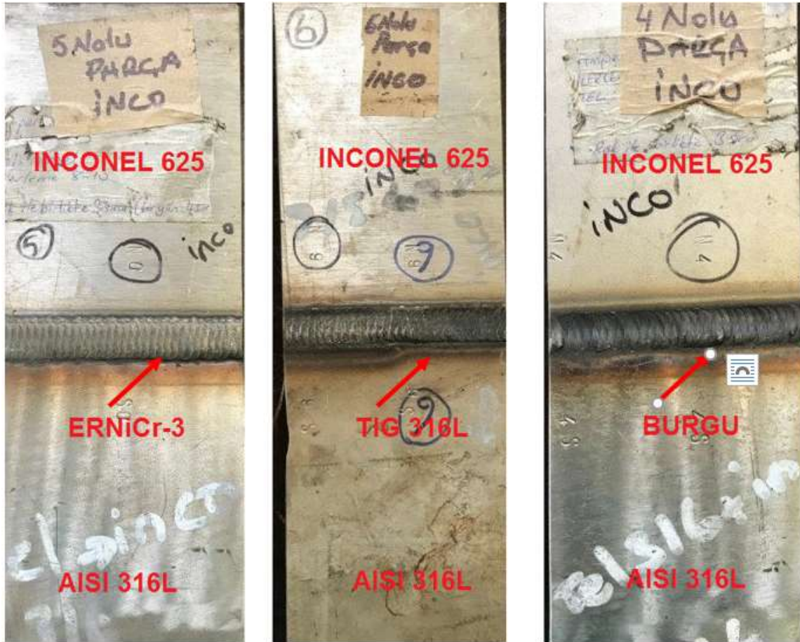
Şekil 4.2. SA/TIG kaynak yöntemi kullanılarak yapılan kaynak dikişleri a) ERNiCr-3, b) TIG 316L, c) Burgü (ErNiCr-3 + TIG 316L)
