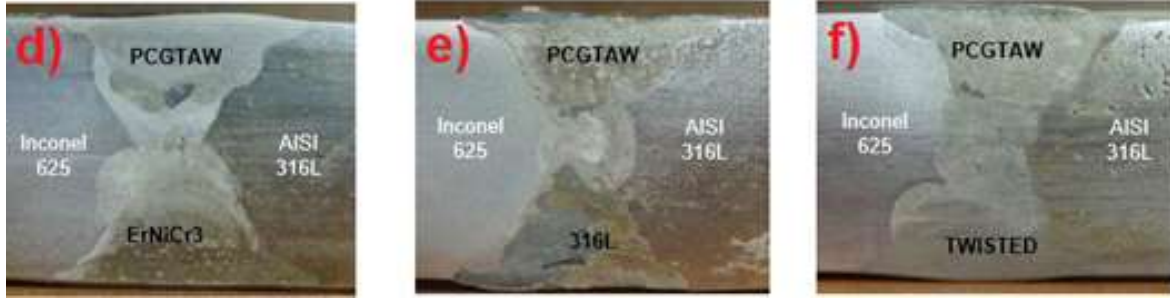
Şekil 4.5. DA/TIG kaynak yöntemi kullanılarak yapılan kaynak dikiş kesitleri d) ERNiCr-3, e) TIG 316L, f) Burgu (ErNiCr-3 + TIG 316L)
