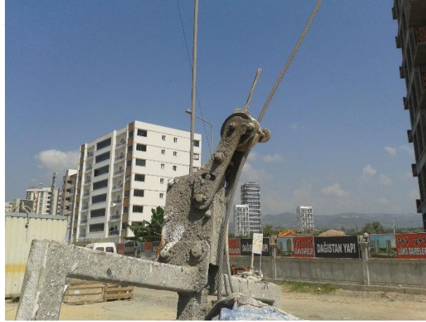
Şekil 2.5. Karşı ağırlıklı asma iskele emniyet freni (Blocstop)
