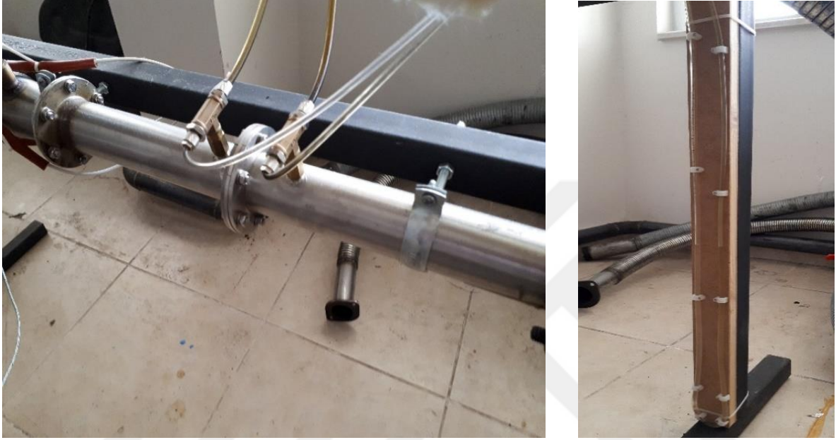
Şekil 3.16. Orifis plakasının yerleştirildiği parça ve U manometre
