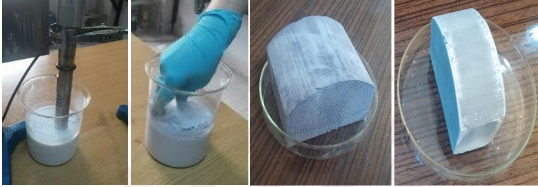
Şekil 3.2. ANP katalizörünün üretim aşamaları
