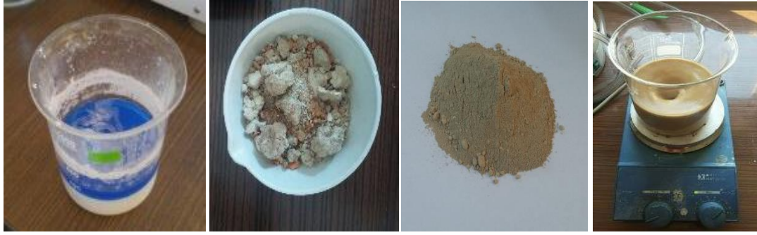
Şekil 3.3. Ti, V, Cu içeren solüsyon hazırlanmasına ait resimler
