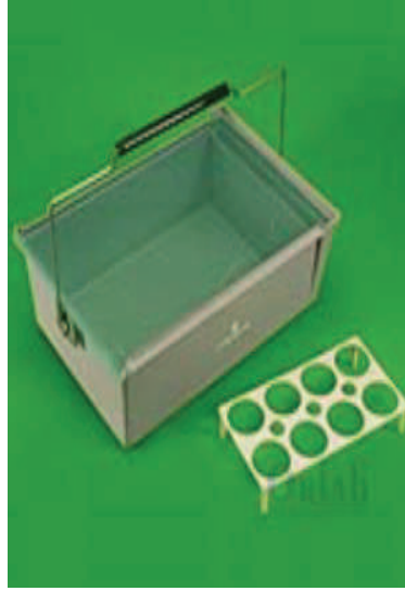
Őekil 2.12. Numune taŐıma sepeti [39].
