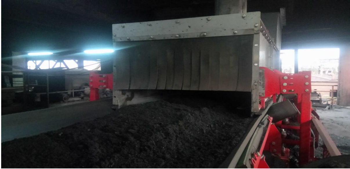
Şekil 4.4. Uygun tasarlanmış transfer şutu.
