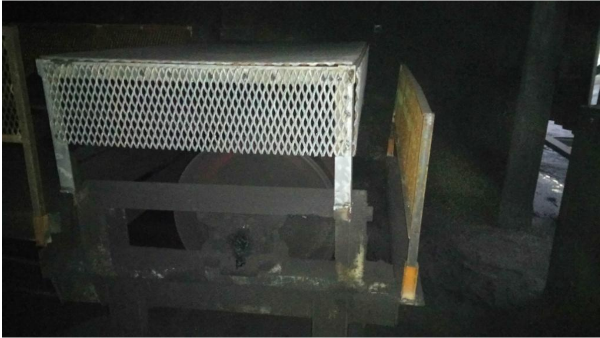
Şekil 4.2. Muhafaza içerisine alınmış kuyruk tamburu.
