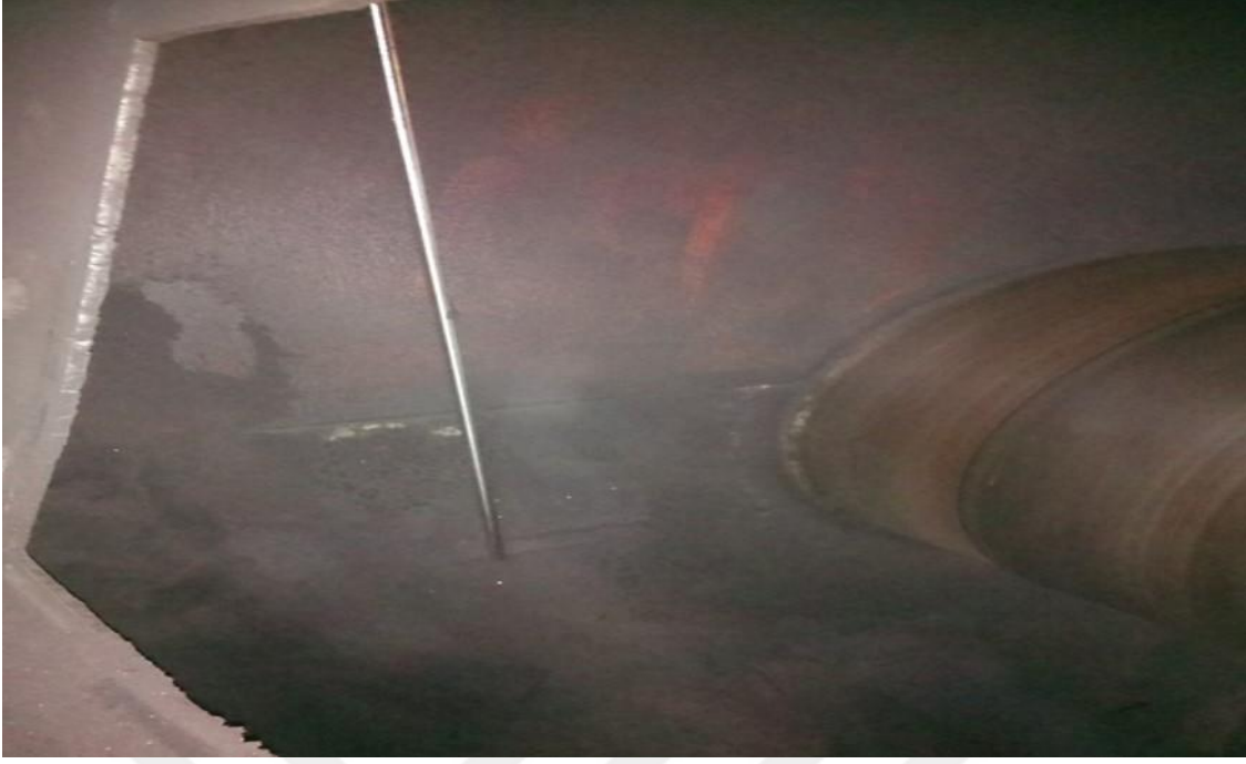
Şekil 4.9. Şut tıkanma çubuğu.
