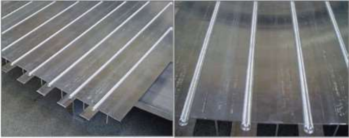
Şekil 2.4. Güverte yan bölme ve zemin panelleri için SKK yöntemi ile birleştirilmiş parçalar [48]
