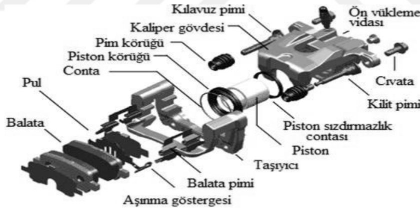
Şekil 2. 4: Fren Kaliperinin Parçaları
