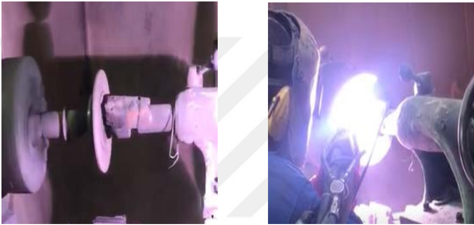
Şekil 5. 2: Seramik Kaplama Anına Ait Resim
