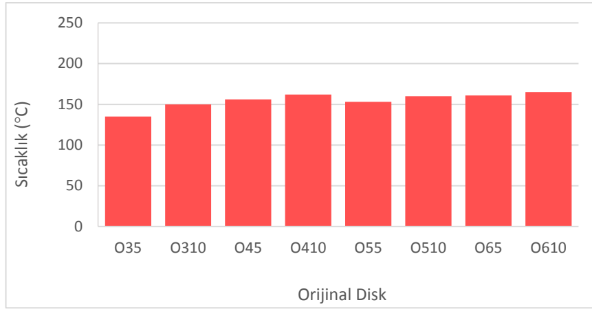
Şekil 6.10. Orijinal diskin devir ve basınç değişimine göre sıcaklık grafiği
