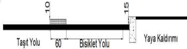
Şekil 6.4. Taşıt Yolundaki Bisiklet Yolunun Refüjle Ayrılması (Bisiklet Yönetmeliği) Kaynak: Bisiklet Yönetmeliği, 2015.
