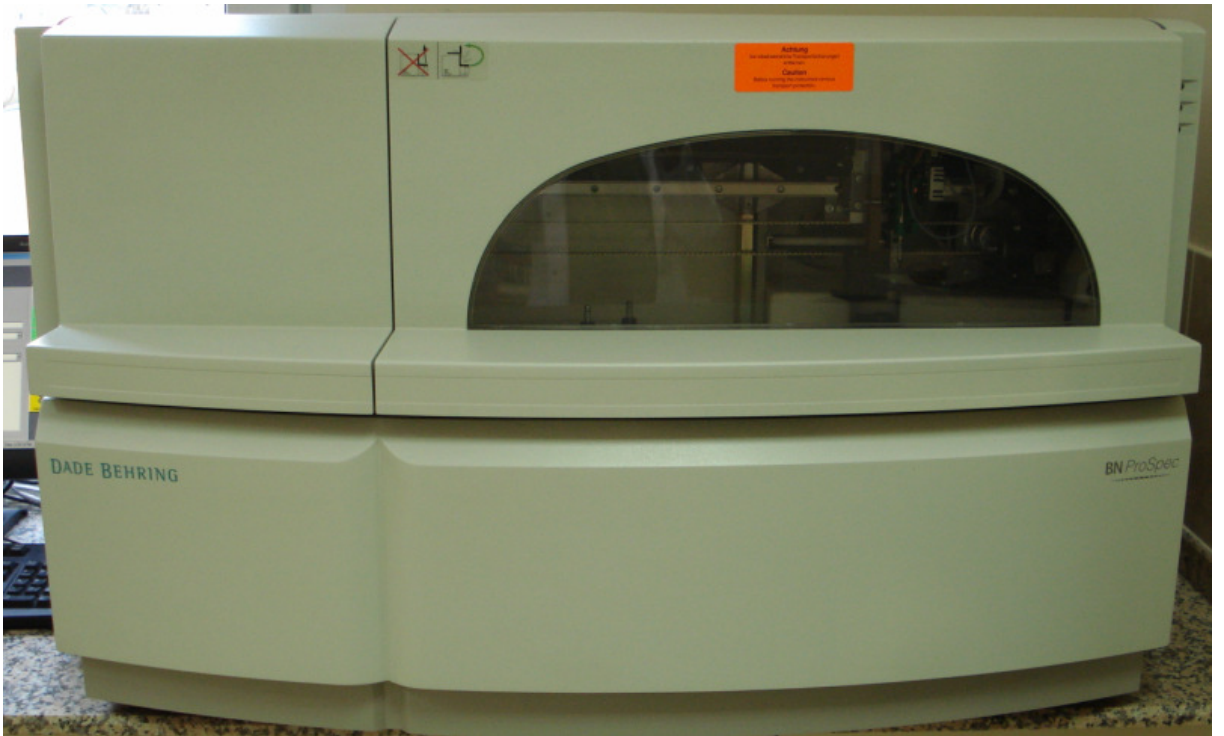
Resim 3: Nefelometrik yöntemle IgE tipleri bakılan cihaz.
