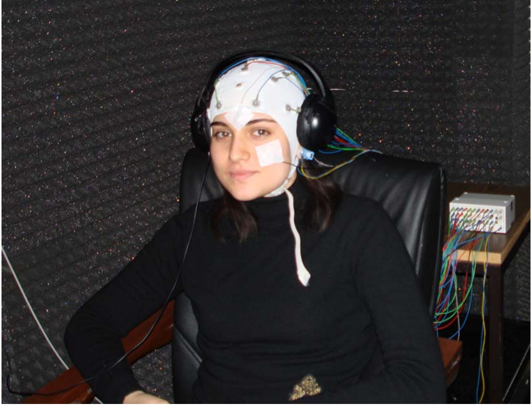
Şekil 3.2. İşitsel olaya ilişkin potansiyel yanıtlarının kaydedilmesi. Faraday kafesi ve ses yalıtımı olan izole bir odadaki deneğe, bir kulaklık aracılığıyla uygulanan işitsel üçlü uyaran paradigmasına yanıt olarak ortaya çıkan OİP bileşenlerinin, saçlı deriye easy cap ile yerleştirilen Ag-AgCl halka elektrotlar aracılığıyla 32 Kanallı La Mont Marka EEG yükselticisi ile kaydedilmesi. Şekilde göz hareketlerinin takibi için yerleştirilmiş EOG kayıt elektrotları da görülmektedir.
