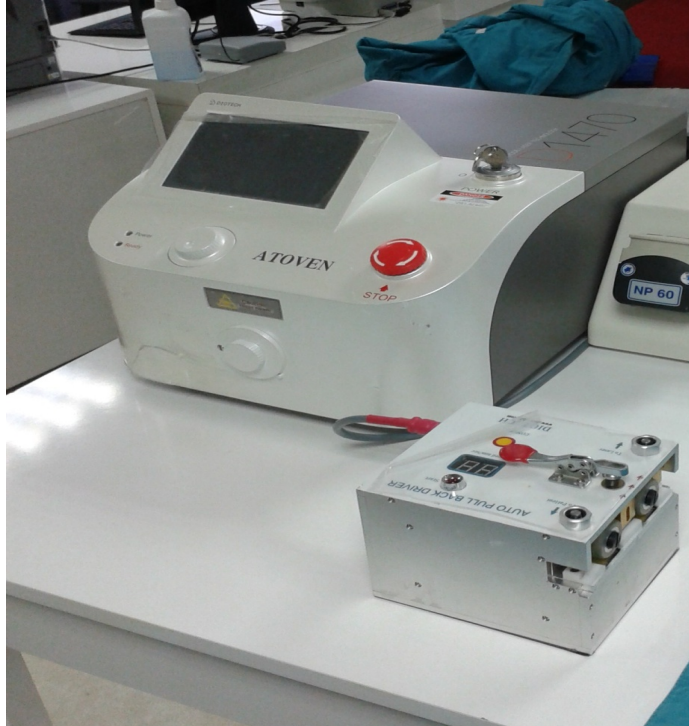
Resim 8. Otomatik lazer fiberi çekme ünitesi ve 1470 nm dalga boylu 15 watt continue lazer cihazı.
