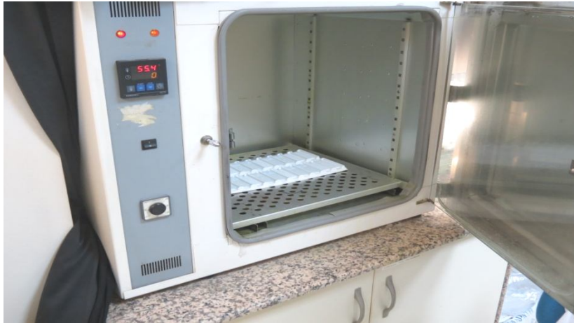
Resim 4: 60 °C etüvde bekletilme aşaması.
