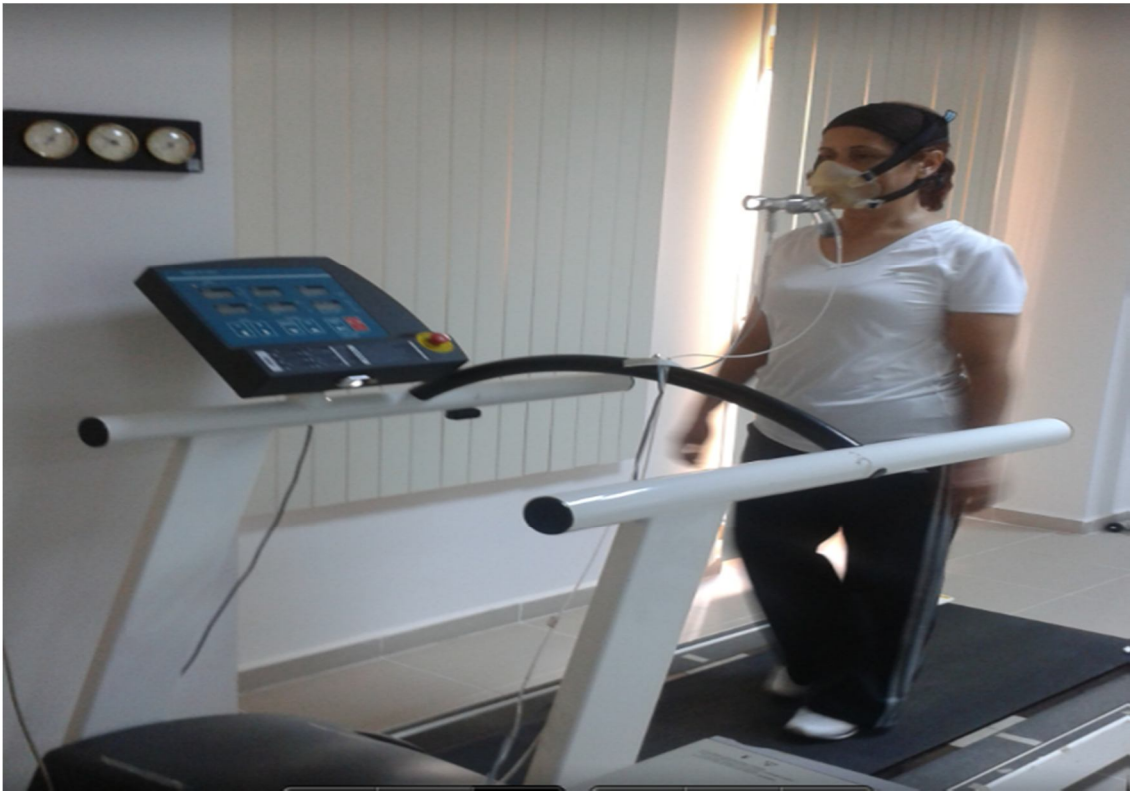
Resim -3 Treadmill'da yürüme sırasında enerji tüketim ölçümü
