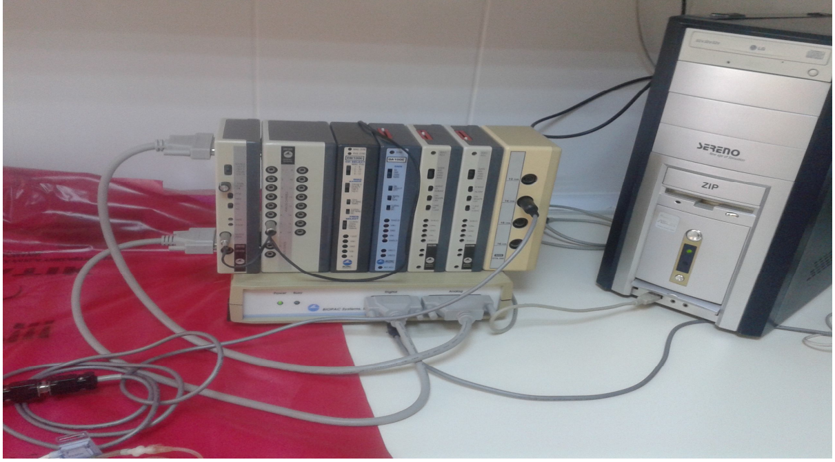
Resim 6: Basınç ölçüm ve kayıt cihazı
