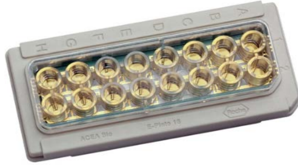
Resim 1: Hücre Kültürü ve İlaçların Yerleştirildiği On Altı Kuyucuklu E-plate 224
