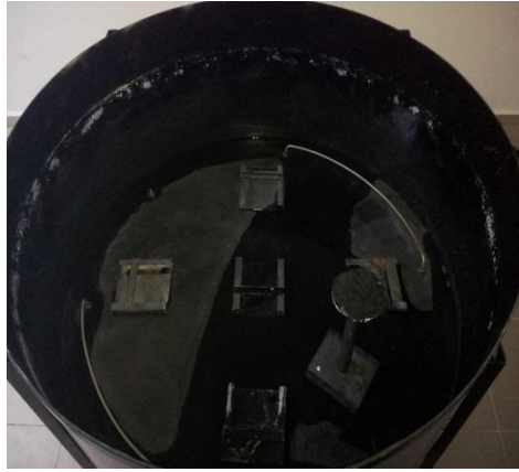
Şekil 3.5. Morris su tankının üstten ve yandan görünümü. (R=150 cm, h=60 cm)
