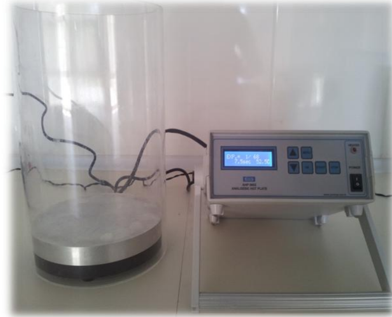
Şekil 3.10. Sıcak plaka (Hot plate) sistemi
