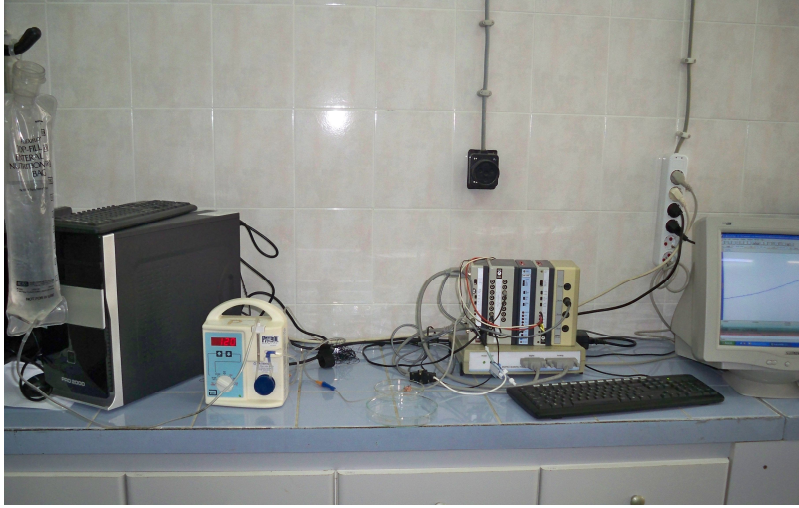
Resim 3. Patlama basıncı ölçüm düzeneği.
