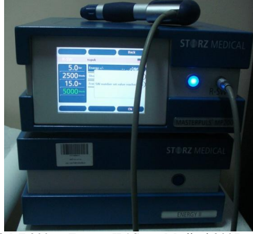
Şekil 3.7. Masterpuls® MP200 ve Energy II ( Storz Medical 2007 model, İsviçre) yüksek frekanslı radyal ESWT cihazı. Teknik özellikleri ise; frekans 1-21 Hz, uygulama basıncı 1-5 bar, atımın en yüksek basıncı 18.5 MPa ve Atım Süresi 200-2000 \mu s'dir.
