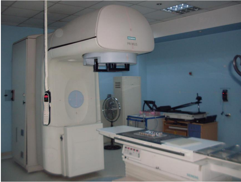
Şekil 3.2. Radyasyon kaynağı: Mersin Devlet Hastanesi Radyo-Onkoloji Ünitesi'nde bulunan Siemens, Primus 3D Plus model Linear Accelerator, 6 MV Photon Beam marka ve model cihaz
