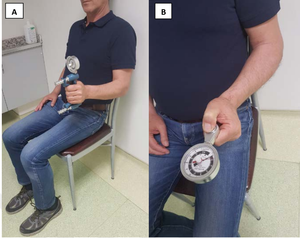
Şekil 49: A) Jamar hidrolik dinamometresi B) Anahtar sıkma gücümetre.
