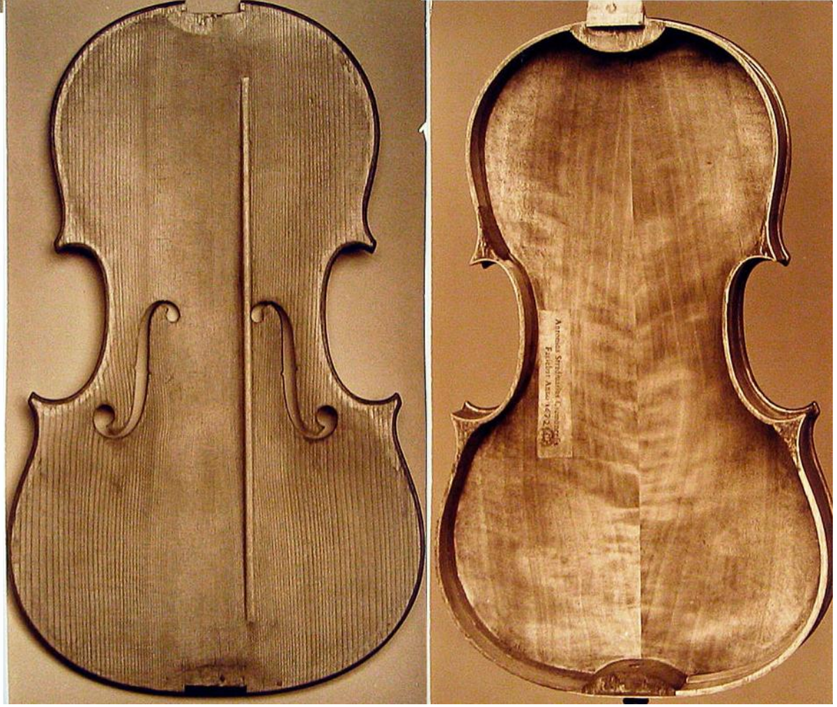
Şekil 5.11. Stradivarius'un ilk viyolası "Mahler" in ön ve arka tablasının içten görünümü ( http://tarisio.com/cozio-archive/property/?ID=41367 )
