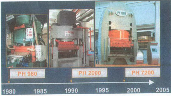
Resim: 60 Endüstriyel karo üretiminde kullanılan preslerinin gelişimi (Sacmi firması).
