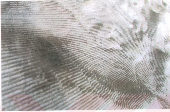
Resim 3.30 : Freze işleminin sonucunda görülen yüzey detayı. Mekanik etkiyi hissettiren çizgisel yüzey dokusu sanatçı tarafından silinerek bitiş gerçekleştirilir. Prof. Rahmi Aksungur mermer rölyef uygulaması, İstanbul 2001.
