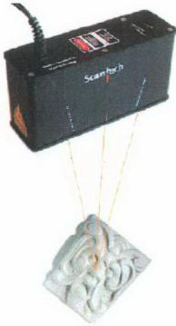
Resim 3.3 : Noktasal laser tarayıcıdan çıkan laser ışını, yüzeyden tarayıcıya olan uzaklığı ölçerek tüm yüzey üzerindeki her bir noktayı tek tek bilgisayar ortamına aktarır. www.scantech.net
