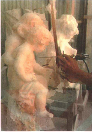
Resim 2.15 : Noktalama aracı ile alınan ölçütün mermer modelden mermer kopyaya taşınması. Walter S. Arnold uygulaması 2001. www.stonecarver.com
