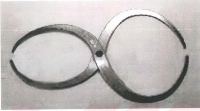
Resim 1.8 : Sadece 1/2 bütölme ya da küçölme yapabilen sabit oranlı pergel
