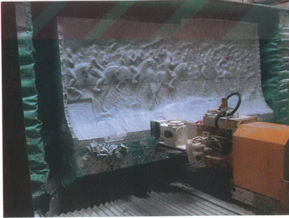
Resim 3.33 : Rölyefin makine tezgahında çalışılması. Prof. Rahmi Aksungur mermer rölyef uygulaması, İstanbul 2001.
