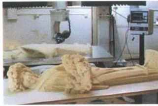
Resim 3.13 : Bir modelin, işe özel yapılmış elle kontrol edilebilen laser tarayıcı ile taranarak ( 1 ve 2 ) bilgisayar ortamına aktarılmasının ( 3 ) ardından, bilgisayar kontrollü bir makine (CNC) tarafından kopyanın üretilmesi ( 4 ve 5 ). www.scansite.com
