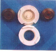
Resim 1,2 : Silikonun, mekanik parça üretiminde kullanımı.
