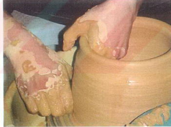
Resim 39 : Çömlekçi tornası ile şekillendirme yapılırken.
