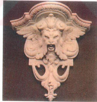
Resim 11 : Silikon kalıp ile elde edilmiş poliester ürün.
