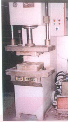
Resim 42 : Plastik çamurla şekillendirme için kullanılan basınçlı pres.
