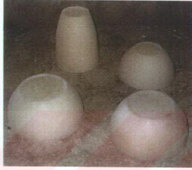
Resim 70 : Altlarına diş açılmış, teksire bağlamaya hazır model çeşitleri.
