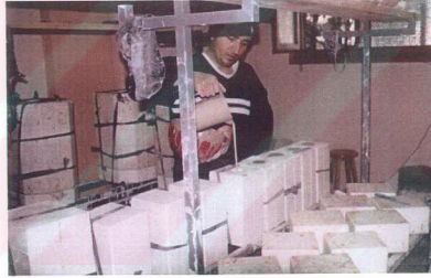
Resim 38 : Alçı kalıpların içine döküm yapılırken.
