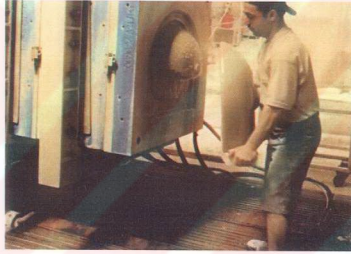
Resim 20 : Basınçlı döküm sisteminde yarı mamul kalıptan çıkartılırken.
