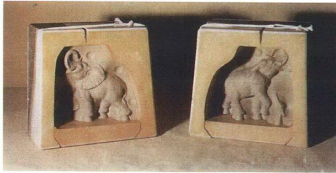
Resim 59 : Dalgulu metod ile epoksiden yapılmış teksir kalıbı.
