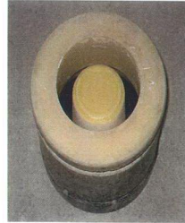
Resim 65,66 : Kestamitden yapılmış bardak teksir kalıbı.
