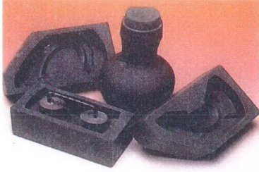
Resim 5 : Silikonun, seramik üretiminde, teksir kalıbı tekniklerinde kullanımı.
