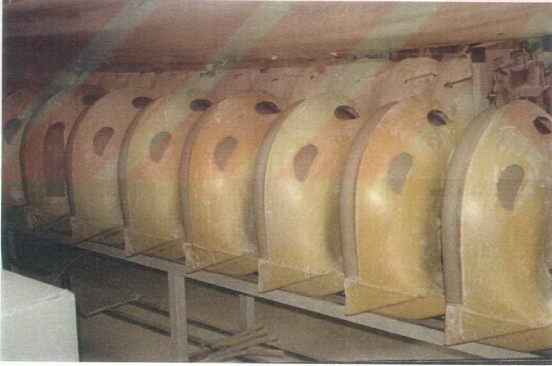
Resim 23 : Poliüretan köpük ceketlerin yarı mamul üzerinde ki görüntüsü.
