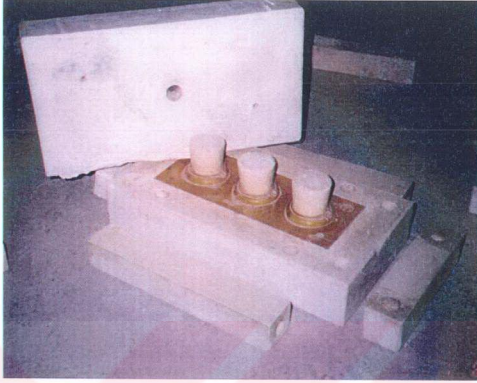
Resim 56 : Matkap ile açılmış döküm deliklerinin gözüktüğü poliüretan dan yapılmış teksir kalıbı.
