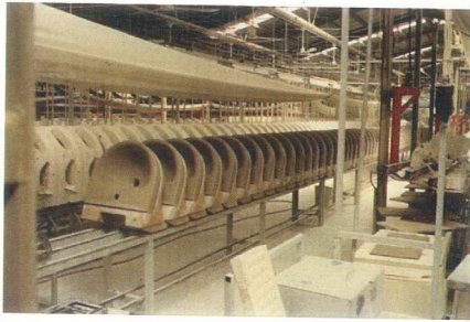
Resim 16 : Batarya döküm sisteminde yarı mamullerin poliüretan köptikten yapılmış ceketler ile kalıplardan çıkartılmış hali.
