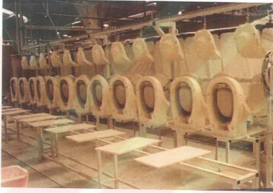
Resim 15 : Batarya döküm sisteminde yarı mamullerin kalıp içerisinde bekletilmesi.
