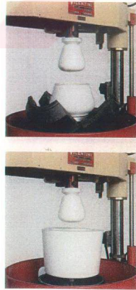
Resim 71,72 : Torna kafaları kestamitden yapılmış yarı otomatik tornalar.
