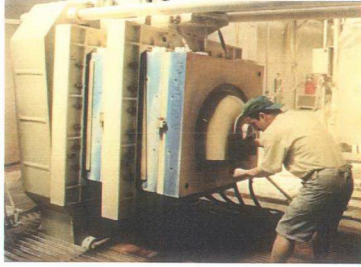
Resim 19 : Basınçlı döküm sisteminde yarı mamul alınırken.
