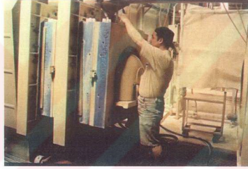
Resim 22 : Poliüretan köpük ceket ile yarı mamulün kalıptan çıkarılışı.
