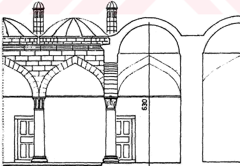
Çizim 4- İstanbul Haseki Hürrem Sultan Medresesi Avlu Revağı Kesit ve Görünüşü Ölçek: 1/100 (I. Dinçel)
