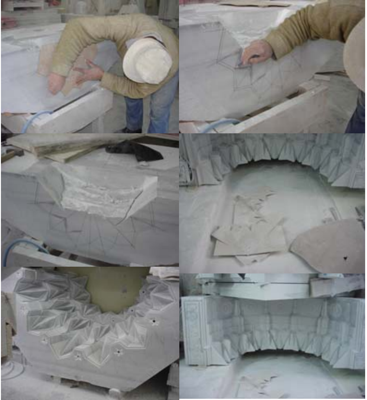
resim 157 , Mihrap bölümünün biçimlendirilmesi
