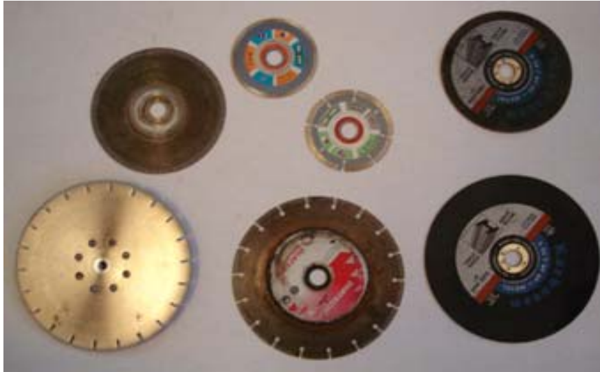
resim 124,Çeşitli boyut ve işlevlerde kesme diskleri
