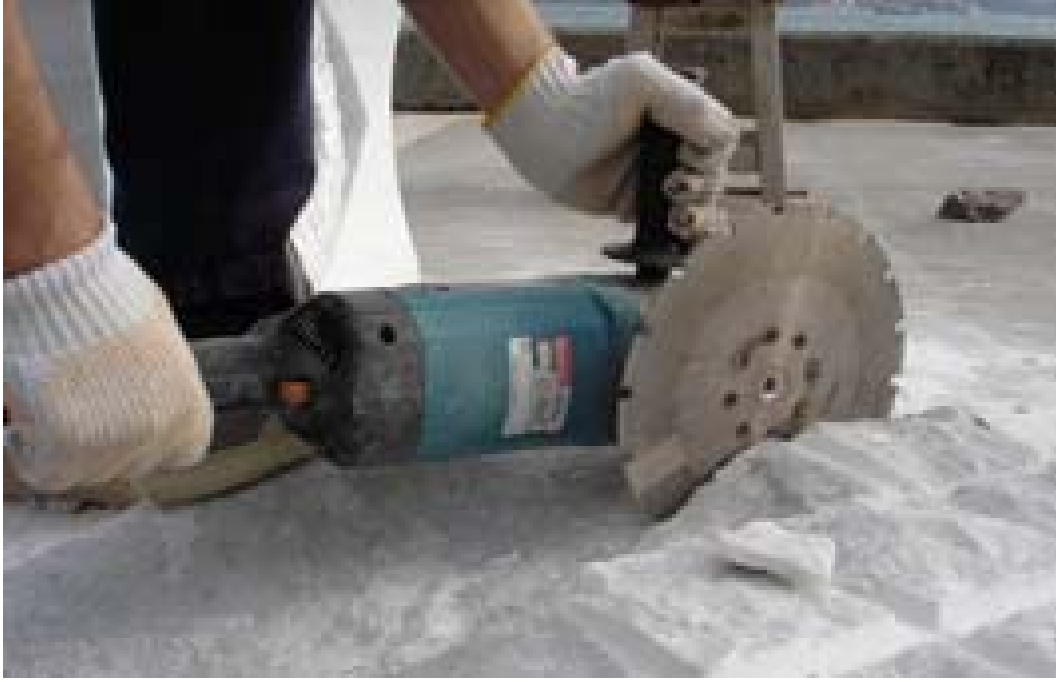
resim 122,Büyük taşlama makinesi ve 230 mm elmas disk
