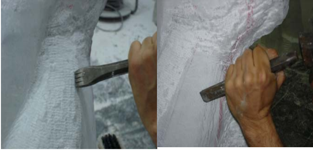
resim 120,Dişli ve keski kullanımı
