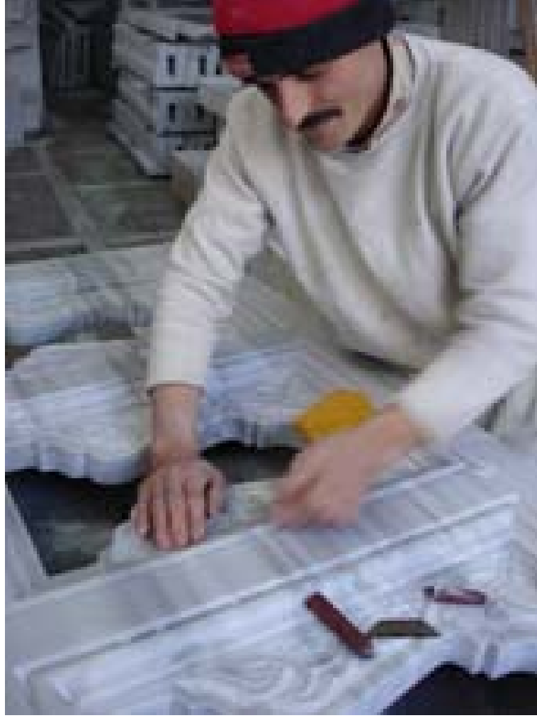
resim 158 , Çalışmaların su ve el zımparası ile tamamlanması
