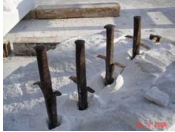
resim 126,Kamalama yöntemi ile taş bölme işlemi
