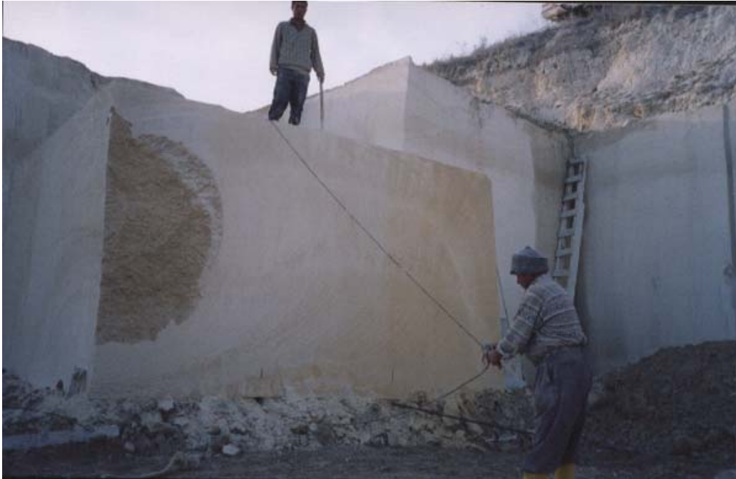
Resim 95, Elmas telin makineye koşulması işlemi
