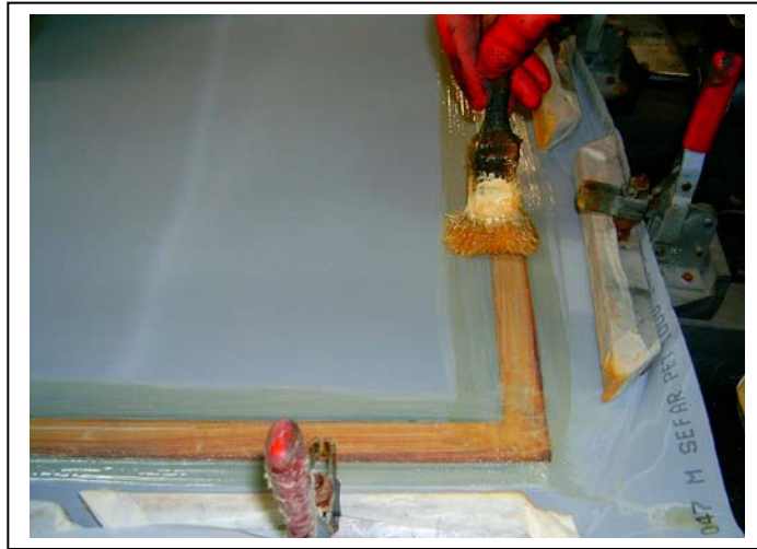
Resim 11: Çift komponentli yapıştırıcıyı fırça ile elek yüzeyine uygulama.
