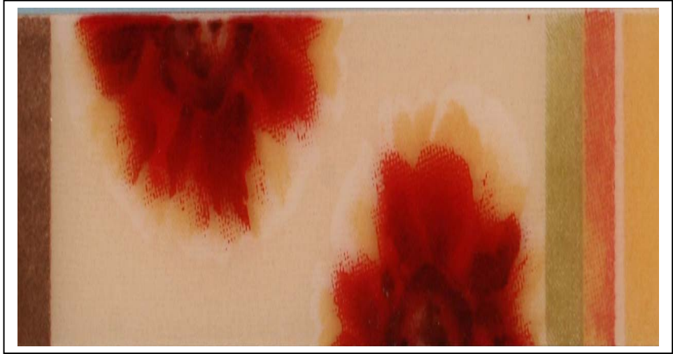
Resim 80: Tasarım/Uygulama; E.K.S Tasarım Grubu/ Kamuran KARAAĞAÇ E.K.S. (VİTRA). Boyut; 20x3cm ve detay. Teknik; sırüstü baskı uygulaması. Yüzey; pişmiş Sırlı. Pişme Derecesi; 830 C°. Elek Bezi Numarası;100–120.
