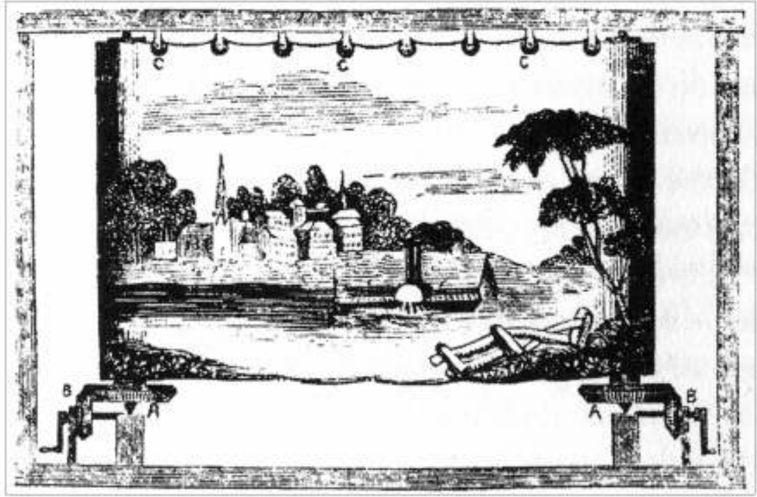
res. 1.27 Bir hareketli doğrusal panorama mekaniğinin şematik çizimi. ( Scientific American , Aralık 1848)
