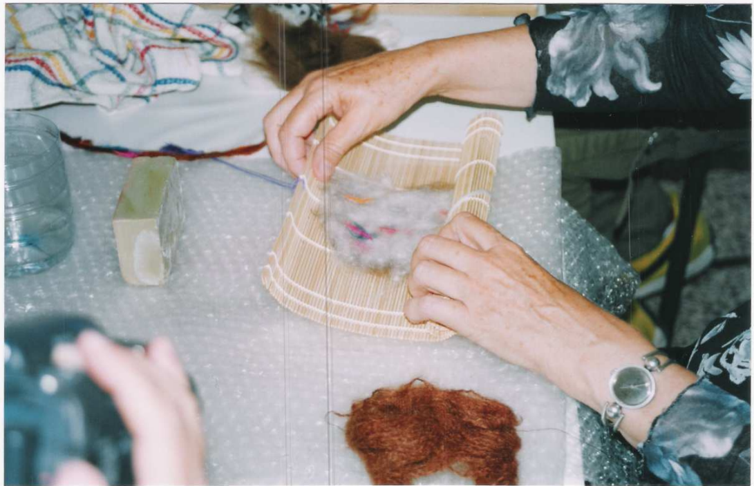
Resim 3.1. Sabunlanan yün öbeği, hasır yardımı ile sıkıştırılarak, keçeleşmenin süratlenmesini ve ürünün güçlenmesini sağlıyoruz. 9 Eylül Üniversitesi, 10 Eylül 2005,İzmir
