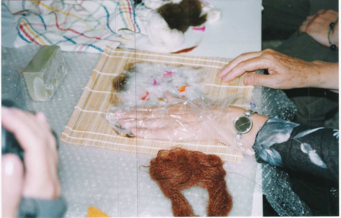
Resim 3. Yapmak istenilen formlar üç katman üzerine yerleştirerek, sabun yardımı ile keçeleşme işlemine devam ediliyor. 9 Eylül Üniversitesi, 10 Eylül 2005,İzmir
