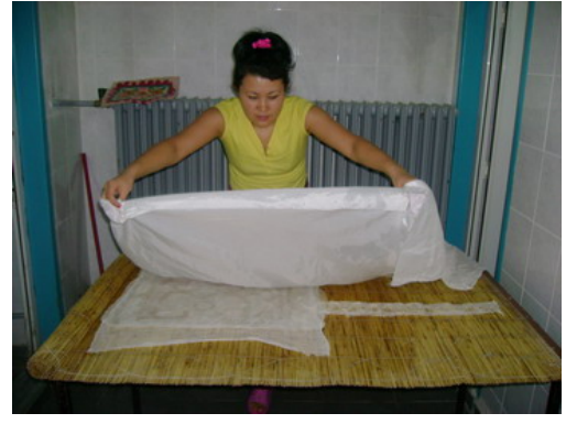
Resim 3.2.18. Örterken modeldeki desenlerinin kaymamasına dikkat edilmelidir
