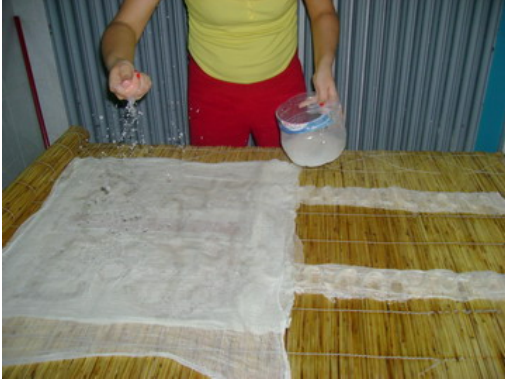
Resim 3.2.13. Model üzerine suyun serpilmesi.
