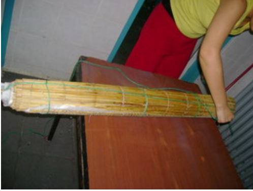
Resim 3.2.31. Dürülmüş hasır, iplerle eşit aralıklarla bağlanmaktadır
