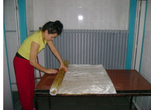
Resim 3.2.26. Hasır sıkıca dürülmelidir.
