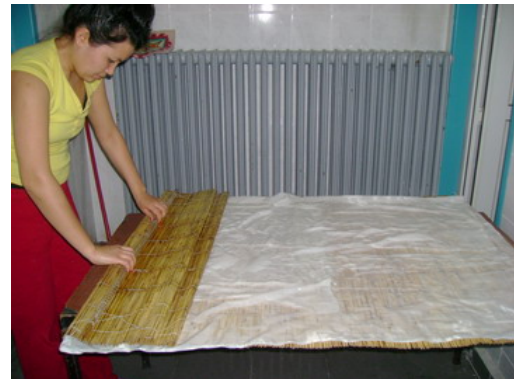
Resim 3.2.24. Hasır modelle beraber bir uçtan dürülmektedir
