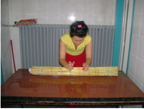
Resim 3.2.33. Dirseklerle dövme (tepme) işlemi gerçekleştirilmektedir. İşlemler tamamlandıktan sonra model yıkanmalı ve kurutulmalıdır.
