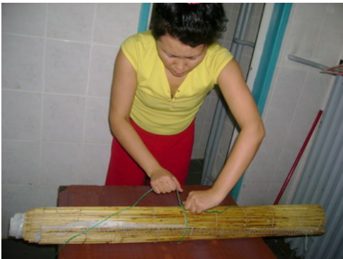
Resim 3.2.29. Dürülmüş hasır, iplerle eşit aralıklarla bağlanmaktadır
