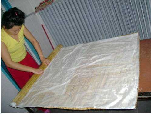
Resim 3.2.25. Hasır, modelle beraber bir uçtan dürülmektedir
