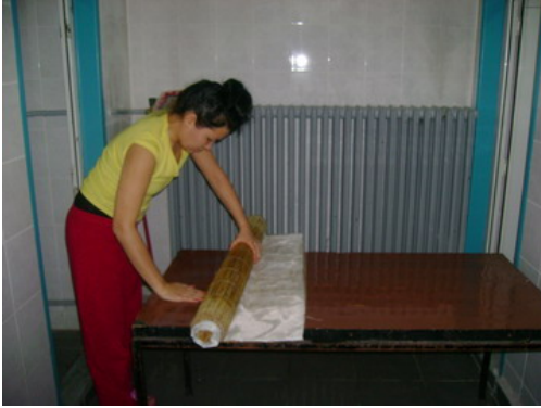
Resim 3.2.27. Dürerken desenlerin kaymamasına dikkat edilmelidir
