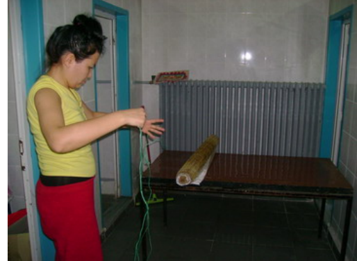
Resim 3.2.28. Dürülmüş hasır, iplerle eşit aralıklarla bağlanmaktadır
