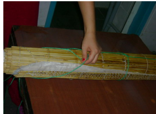
Resim 3.2.30. Dürülmüş hasır, iplerle eşit aralıklarla bağlanmaktadır
