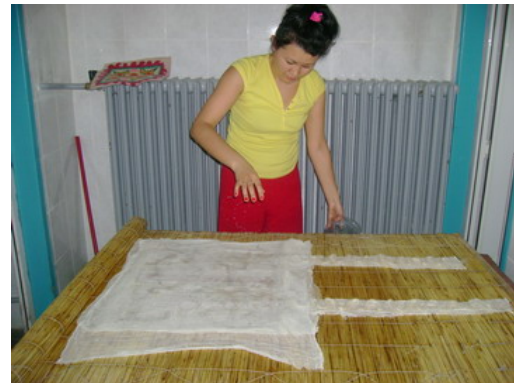
Resim 3.2.12. Modelin tamamı üzerine suyun serpilmesi.
